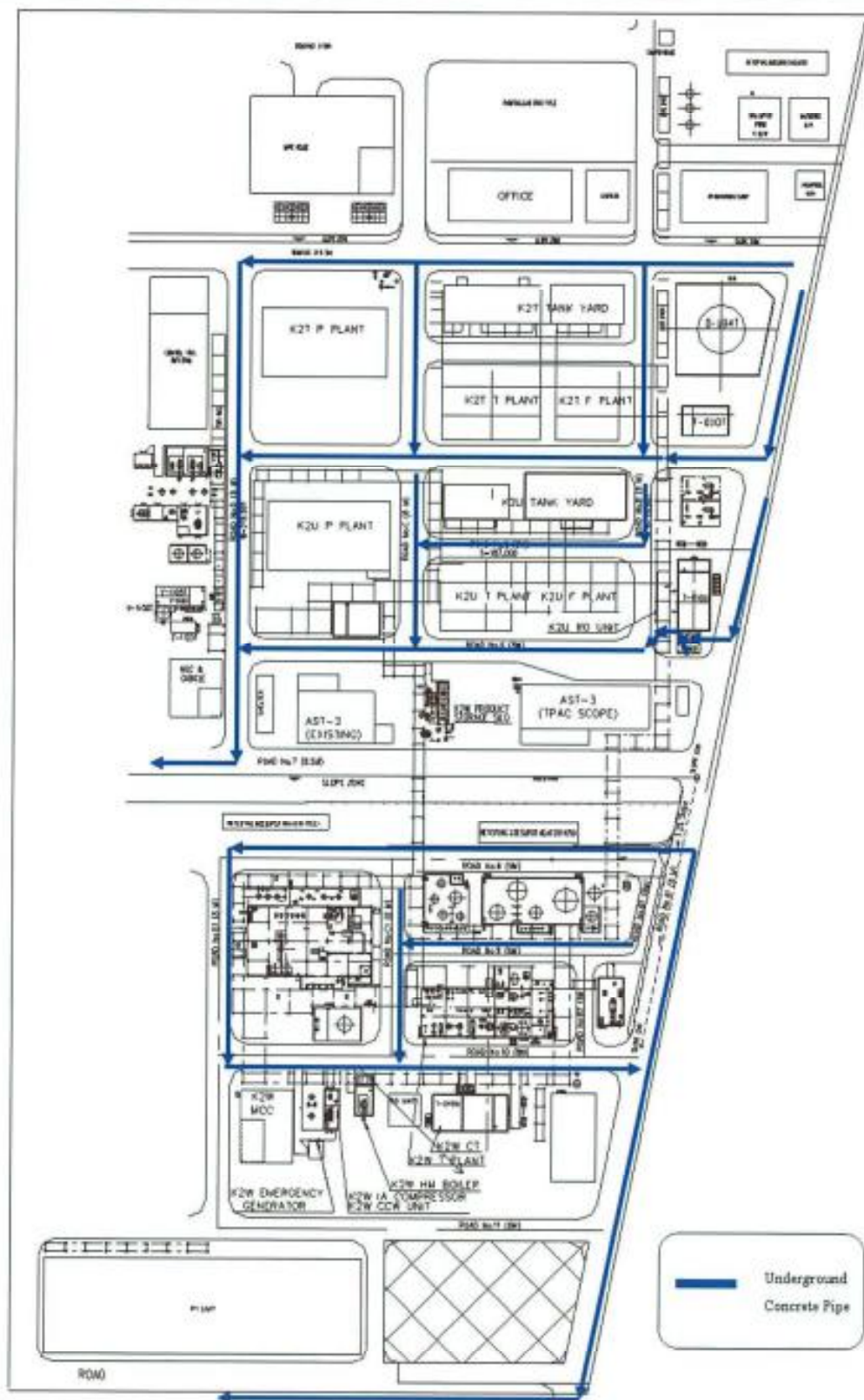
รูปที่ 2.9.1-1 ระบบระบายน้ำฝนไม่ปนเปื้อน บริษัท ไทยไฟฟ้ชีวมวล จำกัด
